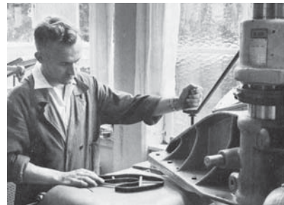
In de stanzerij worden de leren onderdelen van een schoen uit de vellen gesneden (bron: Bata, ca. 1959).
