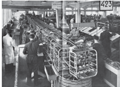
In de schoenfabriek worden het bovenwerk en de zool op een leest samengevoegd (bron: Bata, ca. 1959).
