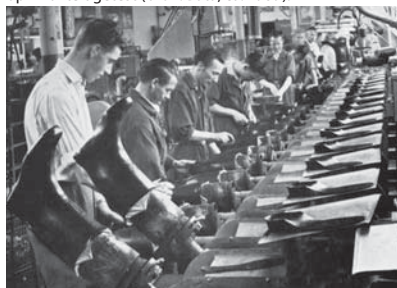
In de laarzenfabriek worden de rubberen onderdelen om de leesten aan elkaar geplakt (bron: Bata, ca. 1959).
