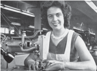
In de stikkerij worden neuzen, zijkanten en hielen aan elkaar gestikt tot het bovenwerk (bron: Bata, ca. 1959).
