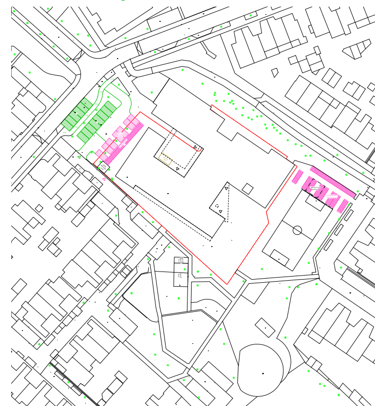
PARKEREN UITWERKING OPTIE 3: 14P op openbaar terrein (6 dwarsparkeren aan straat, 8 in pocket) 7 half op eigen terrein 21P totaal 200P fietsen leerlingen + 30P fietsen personeel
