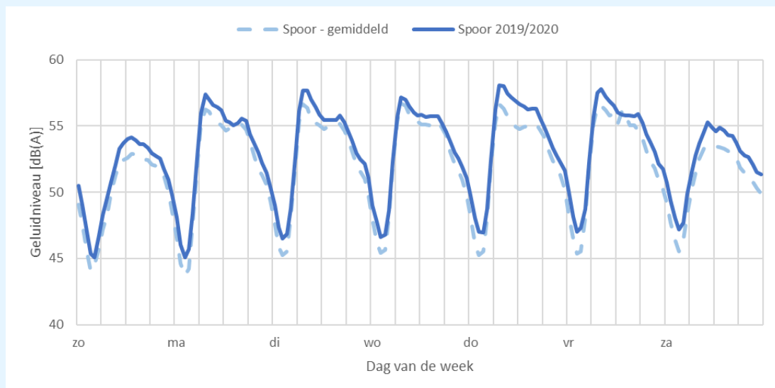
figuur 24: gemiddeld geluidsniveauverloop van wegverkeer gedurende de week voor locatie Spoor. Hierin is te zien het geluidsniveau gedurende meetperiode 2019-2020 (doorgetrokken lijn) en het gemiddelde van de meetperioden ervoor (stippellijn) (lineair gemiddeld)
